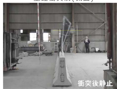
重錘衝突後の最大変形(側面)
