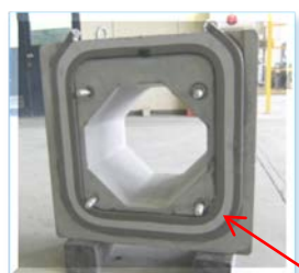
供試体の断面 (写真は 注入工法 )
