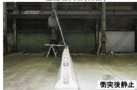
重錘衝突後の最大変形(側面)
